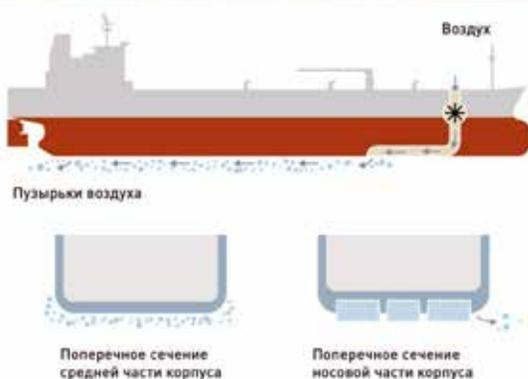
Рис. 6. Эффект изоляции корпуса судна от воды с помощью пузырьков воздуха
